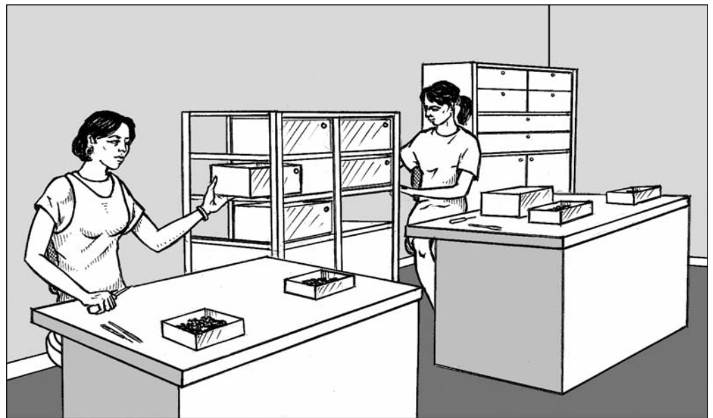
Figure 5a. Prévoir des rayonnages ou des casiers de stockage de façon que les pièces provenant d'un poste de travail puissent passer directement au poste de travail suivant
