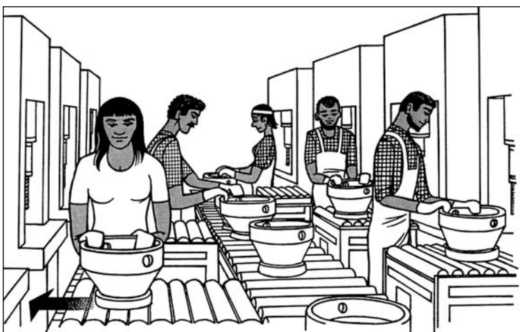
Figure 6b. Chaîne passive de rouleaux pour transporter de lourdes pièces de moteurs à hauteur de service
